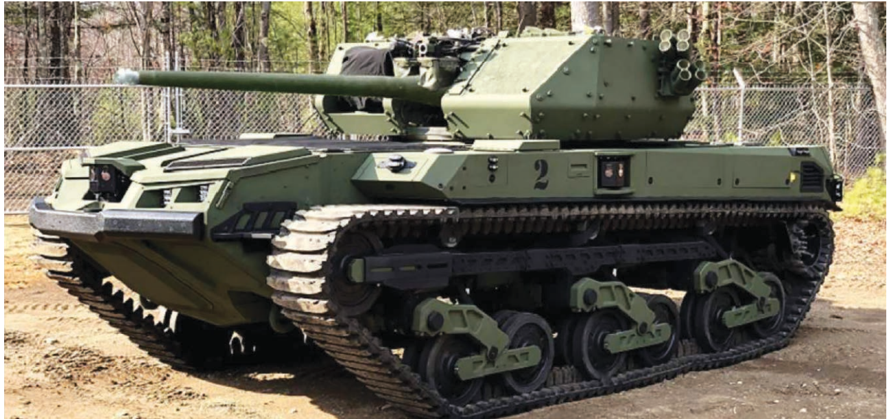
عربة القتال الروبوتية M5 Ripsaw® التي توفر قدرة تحمل غير مسبوقه وقدرات ثورية. يتيح محركها الهجين إجراء مناورات هادئة وزيادة الموثوقية. الصورة: Textron
