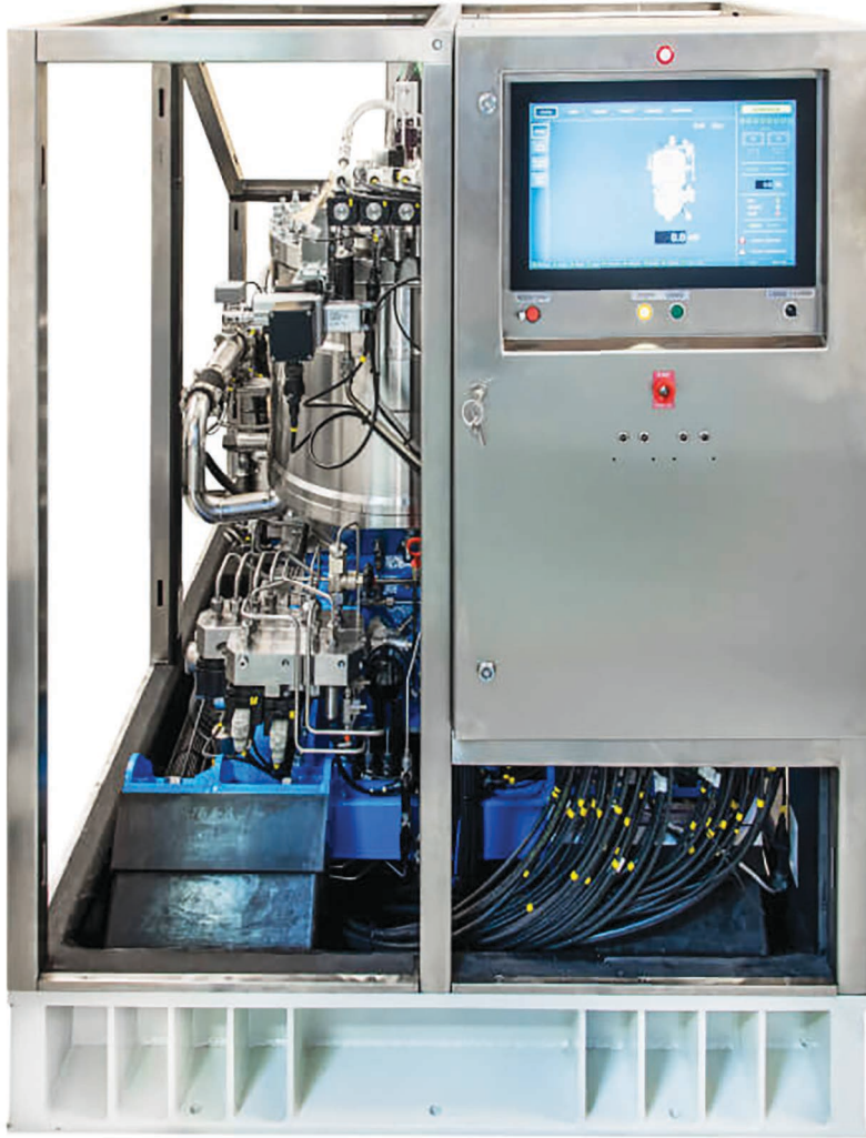
تتميز غواصات A26 المستقبلية التابعة للبحرية السويدية (فئة Blekinge) بالطرز الجديد من نظام الدفع المستقل عن الهواء Stirling AIP
