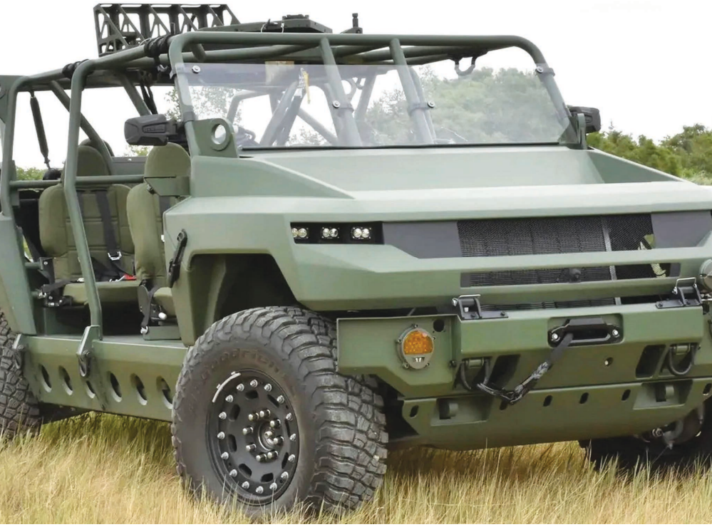
قدّمت شركة GM Defense عربة Hummer كهربائية بالكامل، التي تستخدم بطارية Ultium، لصالح اختبارات الجيش
